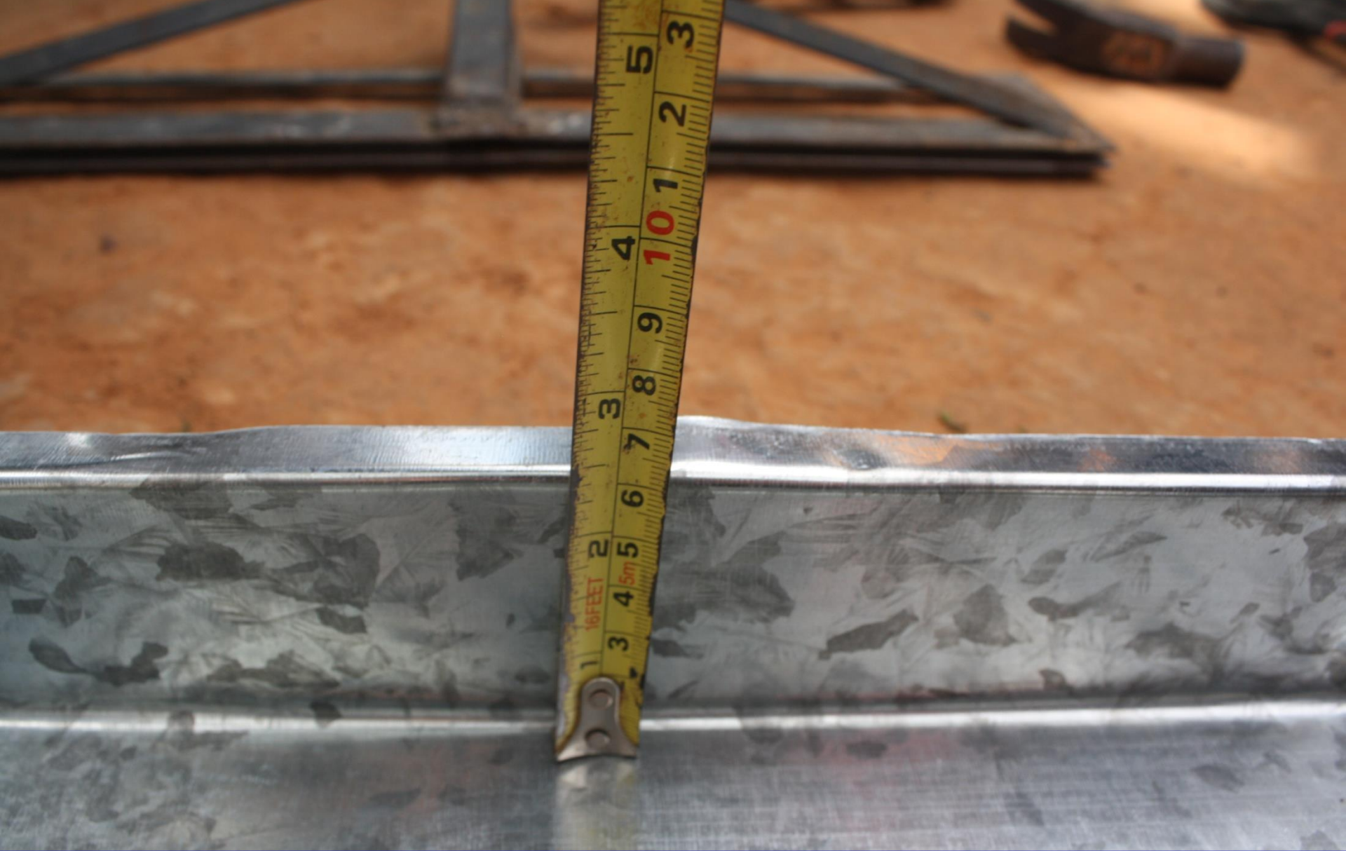
Medida da Altura da Calha (06 cm)
